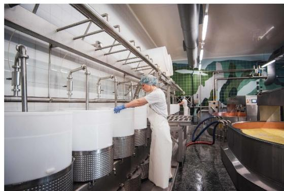
*Un outil de travail performant avec deux cuves de 6600 litres et une de 600 litres permettent la fabrication des différents fromages, à savoir la Tête de Moine AOP, le Gruyère AOP et les spécialités à pâtes mi-dure, le Noirmont, le Roc-Montès, le Taignon et le Franches-Montagnes.*
