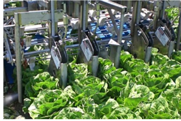
Abbildung 16 : Ein Wasserstrahl schneidet den Salat, danach wird der Salat auf ein Förderband abtransportiert (Quelle: ramsayhighlander.com).
