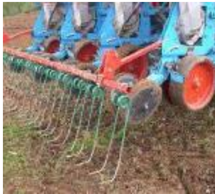
Beispiel bei einer Sämaschine für Mais: Die Lockerungszinken befinden sich hinter den Rädern der Sämaschine.
